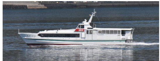
西海沿岸商船の高速旅客船「れぴーど 2」と反航しました。19 総トン型アルミ船です。
